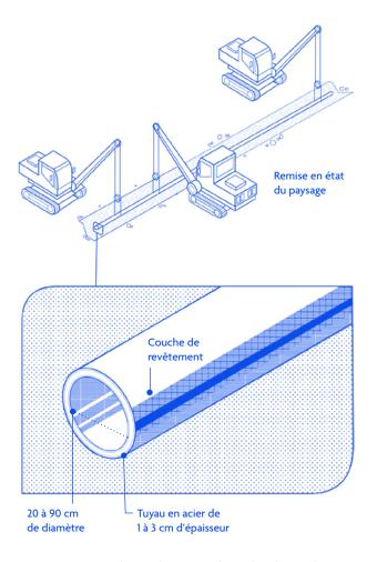
CI-DESSUS: à l'étape du transport, le CO<sub>2</sub> liquide est acheminé par un pipeline conçu spécialement à cet effet jusqu'au centre de stockage. Le pipeline de CO<sub>2</sub> proposé de l'Alliance nouvelles voies suivra, dans la mesure du possible, les tracés de pipelines existants, de façon à minimiser la perturbation des terres.
